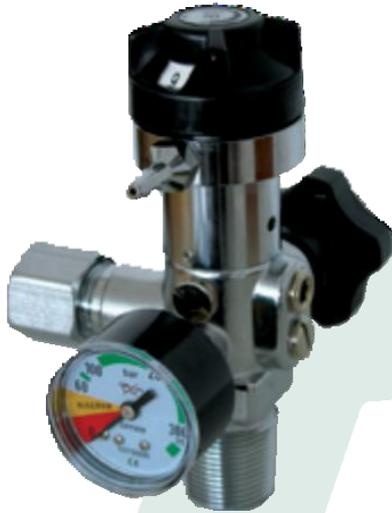
Valvola riduttrice con regolazione a scatto 0-15 lt. min. per uso ossigeno terapia, comprensivo di un riduttore a pistone bilanciato. Portagomma orientabile e sistema residuale. Disponibile con presa Afnor/UNI integrata.
