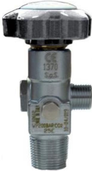
Valvole residuali mod. FUTURA in Ottone cromato per bombole alta pressione. Questa valvola è dotata di un sistema residuale a pressione positiva, con la funzione specifica di impedire la penetrazione di tutte le molecole estranee al gas che si trovano nella bombola lasciando un residuo di gas circa 3 bar.
