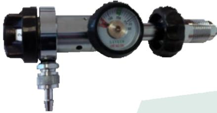
Riduttore di pressione a pistone bilanciato con la regolazione a scatti per l'erogazione del flusso in uscita. Il portagomma è orientabile a 360° facilitando l'inserimento della cannula nasale e/o mascherina.
