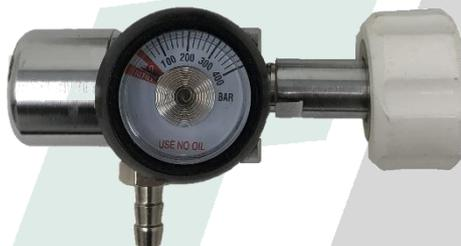
Riduttore di pressione estremamente compatto a pistone bilanciato con taratura fissa idoneo ad alimentare impianti di ambulanze o apparecchiature medicali.
