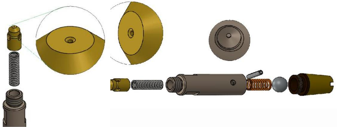
8 Il regolatore di flusso è integrato nel corpo valvola, la sua funzione è quella di aprirsi completamente durante il riempimento della bombola e di restringere il passaggio, tramite un foro pre-calibrato, durante il riempimento dell'uscita. Riduce il flusso preserva il Sistema di carica dell'AIRGUN, aumenta i tempi di ricarica evitando surriscaldamenti e colpi d'ariete
